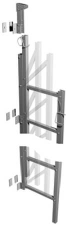
Kuva 4. Periaatekuva aukeavasta tikkaasta
